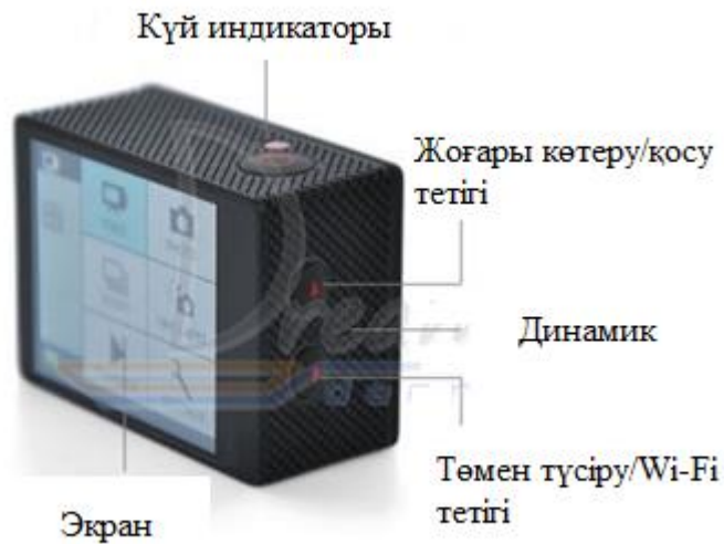
Сурет 2.2 – Ultra HD 4K камерасының артқы бөлігі
